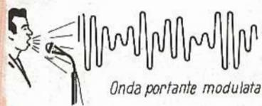
Onda sonora trasformata in un'onda di tensione.
