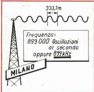
Un'onda elettromagnetica « portante » ha una frequenza ben determinata per esempio Milano 1 ha una frequenza di 899 kHz corrispondente ad una lunghezza d'onda di 333,7 m.
